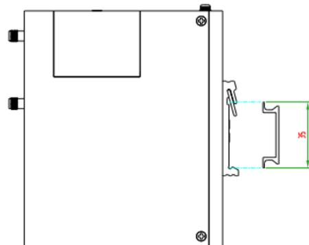
Verwenden Sie M3\*6-Flachkopfschrauben (3 St.), um die Tragschiene am Router zu befestigen, und hängen Sie die Tragschiene dann an die Montagehalterung. Es ist notwendig, einen Standardbügel zu wählen.
