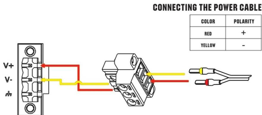
Der DSR-211 Router bietet einen Verpolungsschutz. Zum korrekten Anschluss des Netzteils ist aber stets die Abbildung oben zu beachten. Zum Netzteil gehören zwei Kabel. In Anlehnung an die Farbe des Kopfes schließen Sie das rot markierte Kabel über einen Klemmenblock an den Pluspol an und verbinden das gelbe Kabel auf die gleiche Weise mit dem Minuspol. Der letzte Schritt ist das Einstecken des Netzadapters in Ihre Steckdose.
