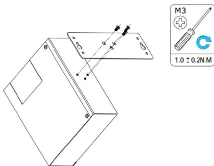
Verwenden Sie M3\*4-Flachkopfschrauben (3 St.), um den Wandmontagesatz am Router zu befestigen, und verwenden Sie dann M3-Trockenbauschrauben (2 St.), um den Router samt Wandmontagesatz an der Wand zu befestigen.
