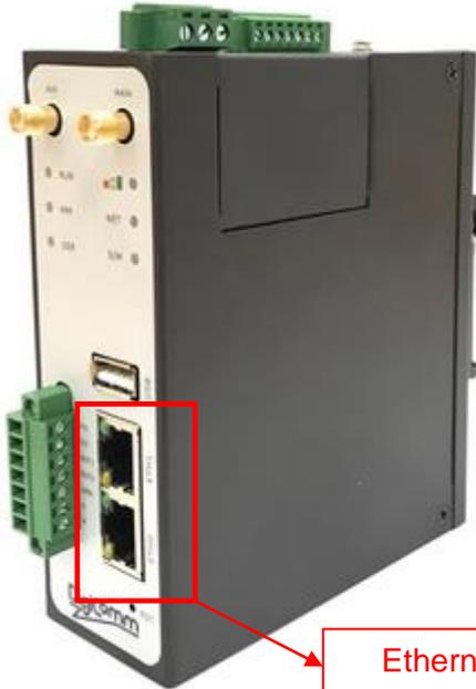
Der DSR-211 Router verfügt über zwei Ethernet-Ports ETH0 und ETH1. Jeder Ethernet-Port verfügt über zwei LED-Anzeigen (siehe Abbildung links). Die gelbe Anzeige ist ein Link-Indikator, die grüne ein Geschwindigkeitsindikator. Einzelheiten zum Status finden Sie in der folgenden Tabelle.
